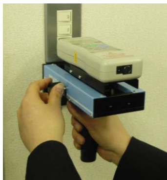
【MS-01:ハンドルの使用例】 壁スイッチの押し心地検査
