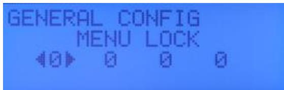
設定した測定条件を誤って変更されないようにパスワードを設定することができます。
