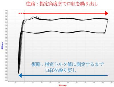
繰り出しを開始後、設定した角度(480°)に達すると自動で一旦停止、逆回転を開始。その後、設定したトルク値(-0.650N-m)に達すると自動停止。同じサイクルを10回繰り返してトルク値の変化を分析。
