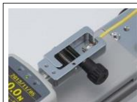
測定イメージ (端子のかしめ力引張強度測定)
