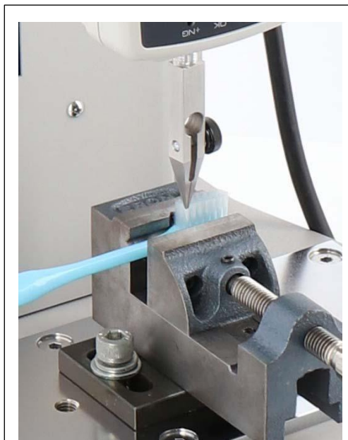
測定イメージ (ブラシの引張抜け強度測定)
