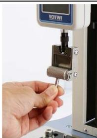
試料を隙間に差し込みます。
