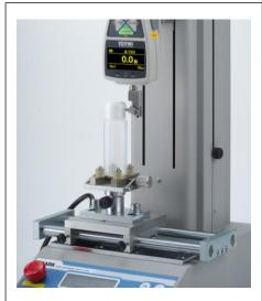
HFC-50N 測定イメージ (ヒンジキャップの開封試験)
