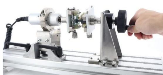
ボリュームスイッチを回すトルク測定
