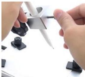
アームが水平になるように、カウンターウエイトの位置を調整した後、昇降ハンドルを回して接触子と平面試験体を接触させます。
