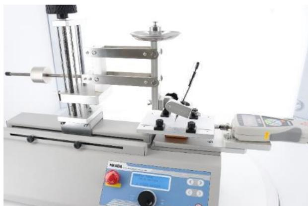
VWF-10N-J を用いたペンの摩擦力測定例 (※)
