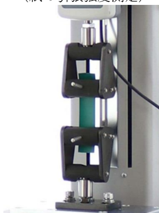
測定イメージ (ラバーシートの引張強度測定)
