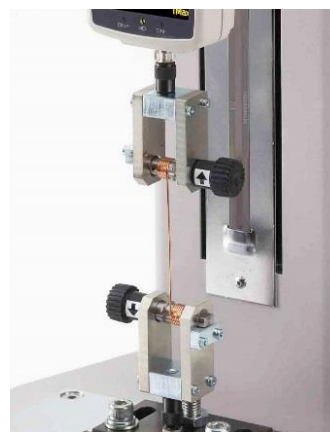
測定イメージ (銅線の引張強度測定)
