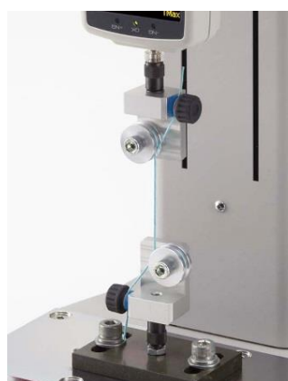
測定イメージ (繊維の引張強度測定)
